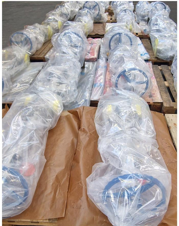
Vannes nettoyées à l'oxygène, prêtes à être expédiées.
